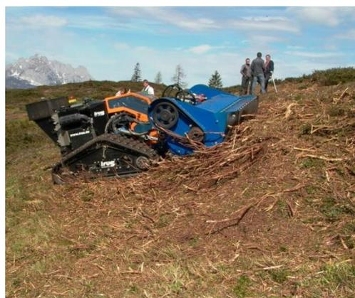
**Abbildung 13: Ferngesteuertes Gerät zum Schlegeln steiler Flächen.
