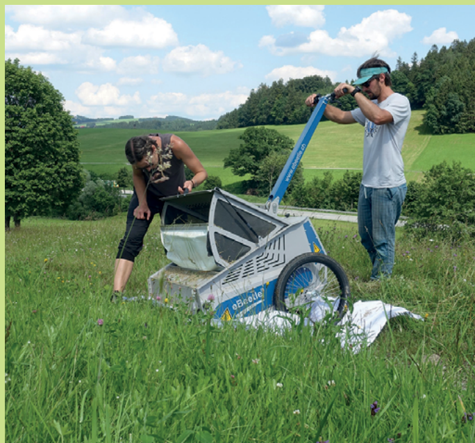
Die Entleerung des Ernteguts beim eBeetle 2.0 erfolgt durch Hochheben des Sammelbehälters, wodurch das geerntete Material nach unten auf ein vorbereitetes Leintuch herausrutschen kann.
